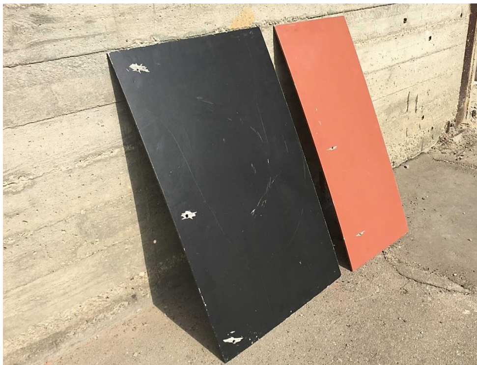
Рисунок 5 – Общий вид образцов во время определения температуры нагрева поверхности плит
