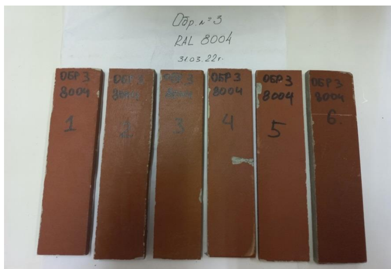
Рисунок 3 – Общий вид образцов фиброцементных плит красного цвета до испытаний с лицевой поверхности
