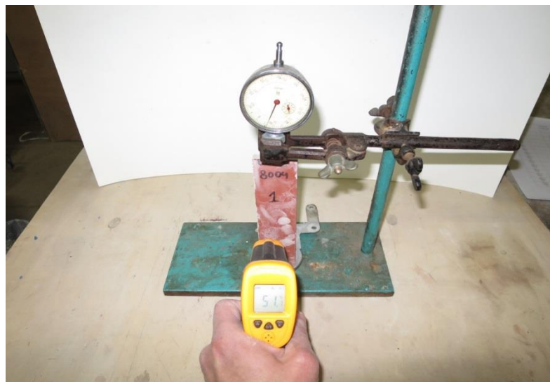
Рисунок 4 – Общий вид образцов в процессе определения коэффициента теплового линейного расширения по длине
